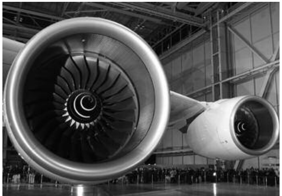
Obwohl geringfügig kleiner als die Triebwerke der 777, sind diese Trent-900-Motoren mit 35 Tonnen Schub und 2,9 Meter Fan-Durchmesser imposante Erscheinungen.
