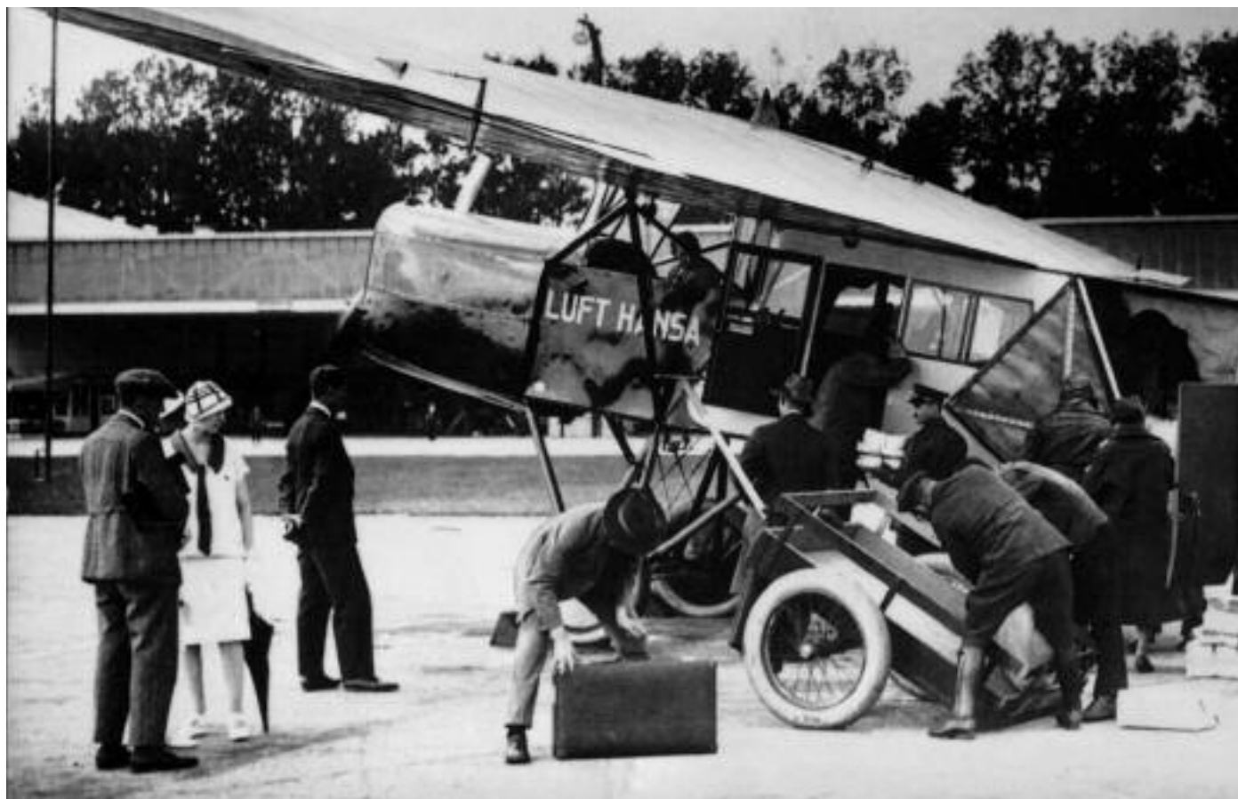
Fokker-Grulich-FII-Hochdecker mit einer Reisegeschwindigkeit von 120 km/h und einer Kabine für vier Passagiere.
