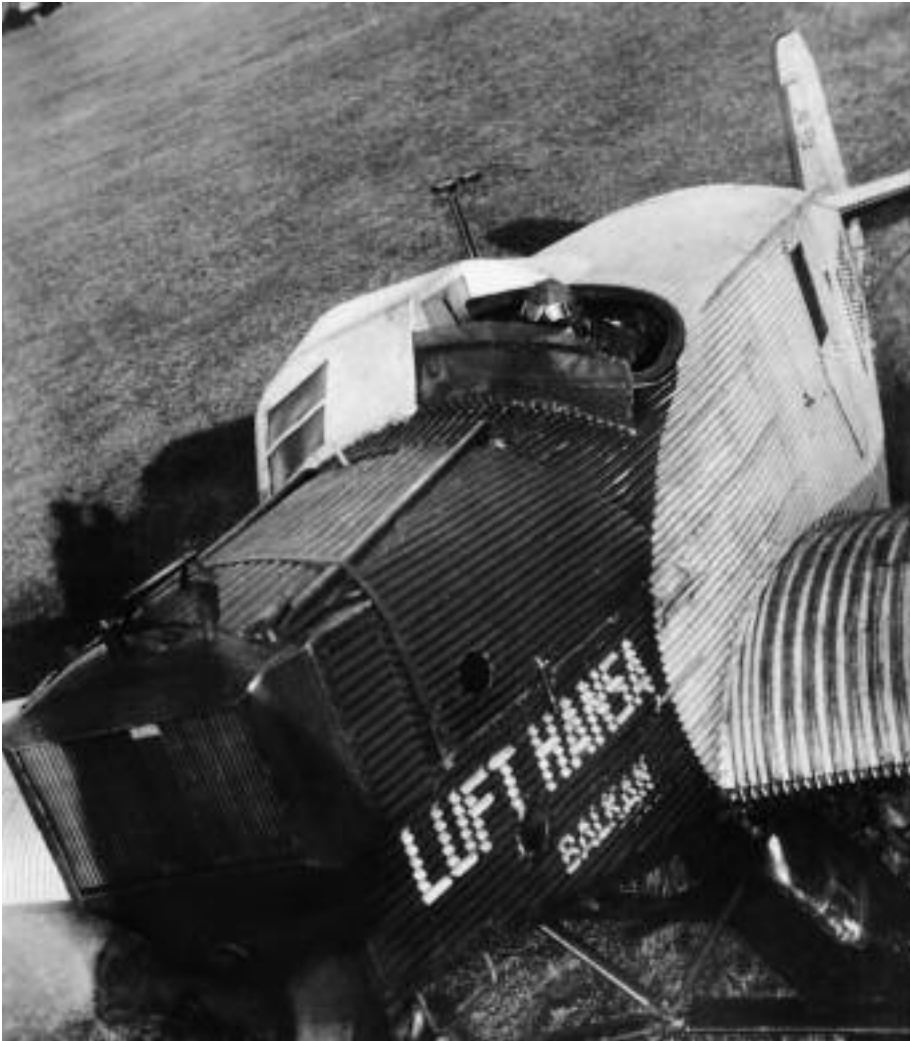
Eine für das Blindflugtraining umgebaute Junker W33. Der Schüler sitzt in der abgedeckten Cockpit-Hälfte.
