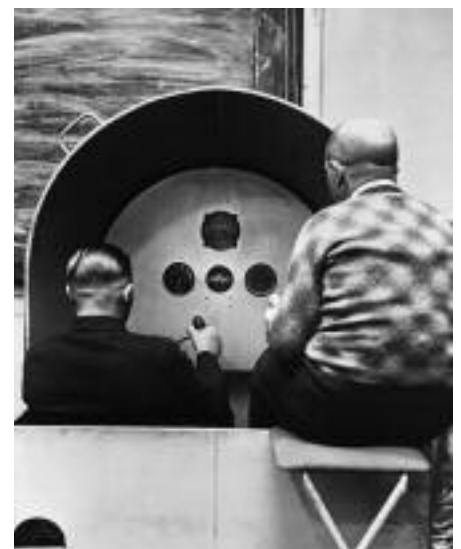
1928/29 beginnt die Lufthansa mit der systematischen Ausbildung der Flugzeugführer im Blind- und Instrumentenflug. Für die Schulung werden besondere Kabinen entwickelt.
