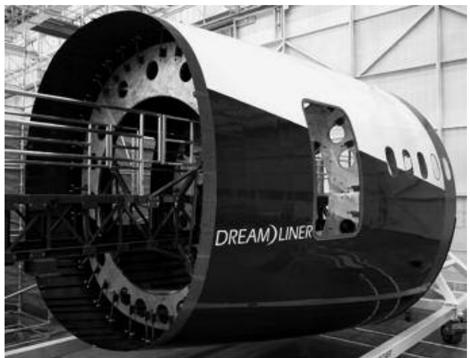
Gewickelt statt genietet: Erstes Rumpsegment der Boeing 787.
