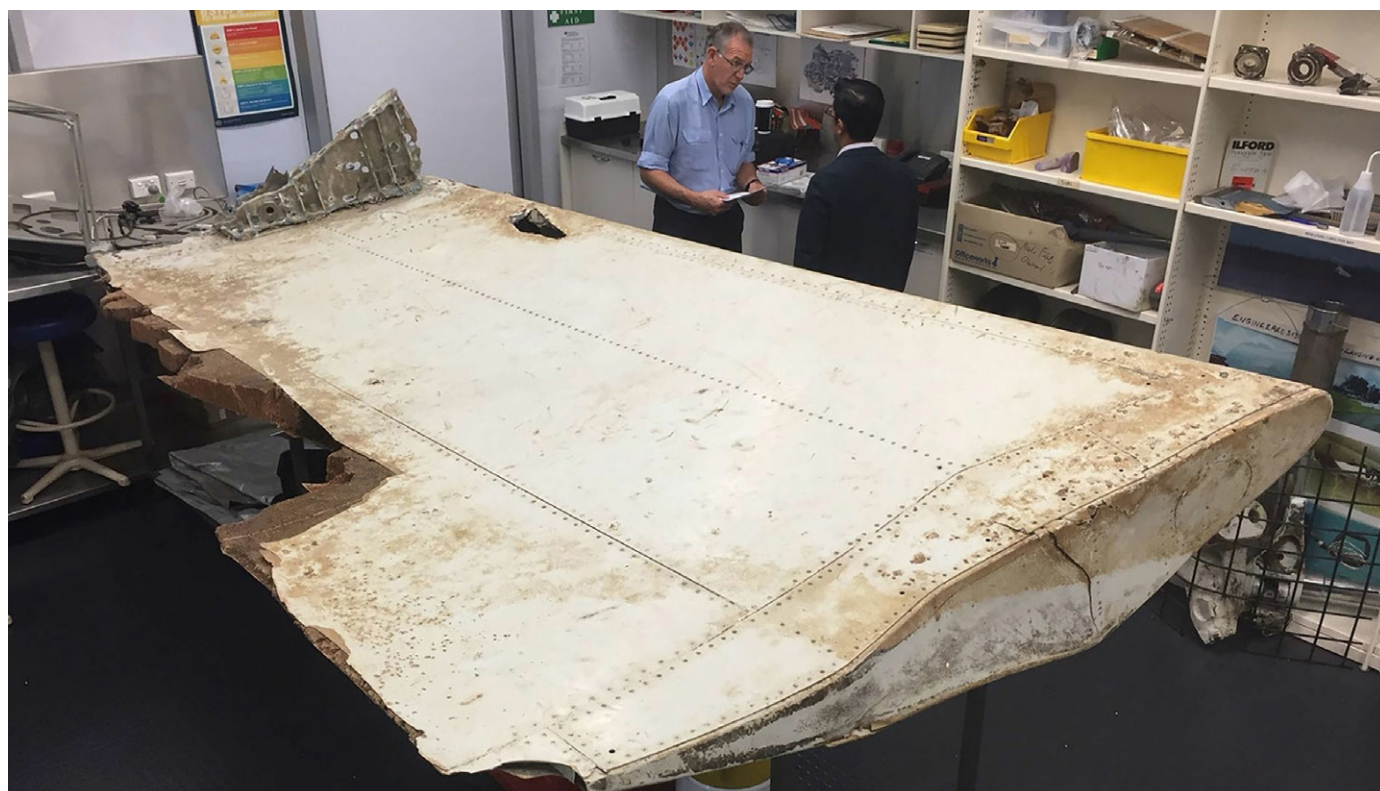
Eines der grössten Wrackteile, das bisher gefunden werden konnte: rechtes Flaperon der 9M-MRO.
