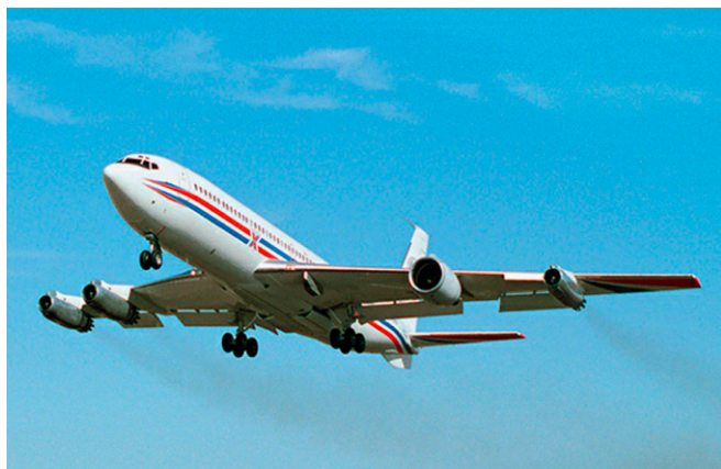
Erprobung des CFM56-5C unter dem linken Flügel einer Boeing 707-300.
