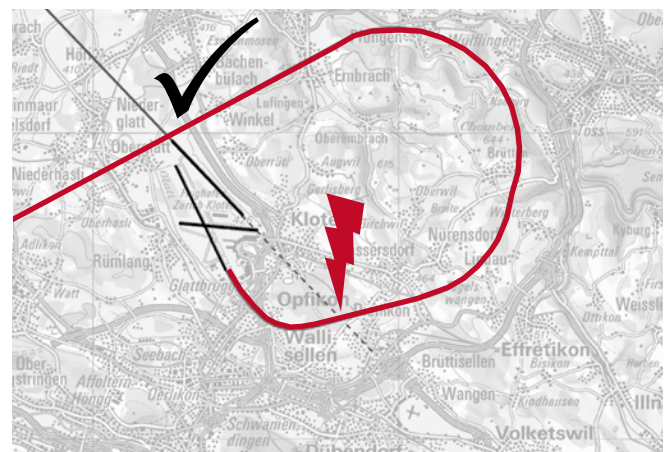
Grafik 1: Mit einem weiteren Flugweg (SIL2) sollen die ab Piste 16 startenden Flugzeuge vertikal von eventuellen Durchstarts von Piste 14 gestaffelt werden.
