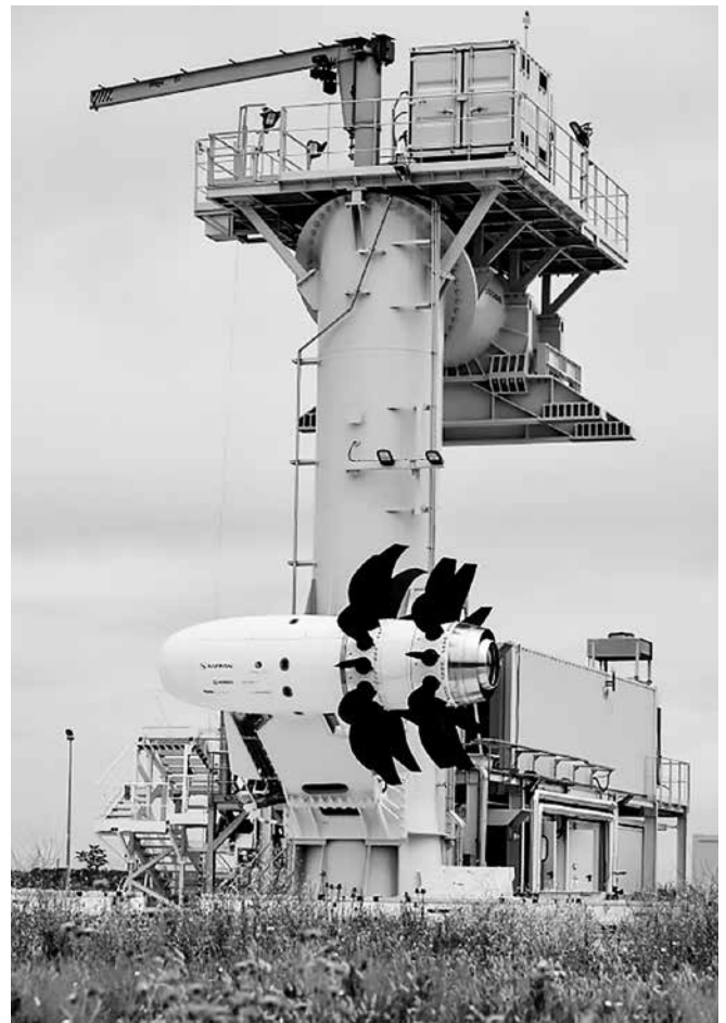
Für die Testläufe des Open Rotor wurde in Istres ein Freiluftprüfstand errichtet. Hier soll in Zukunft auch der UHBR-Fan getestet werden.
