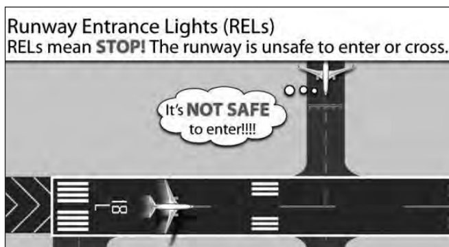
Die Runway Entrance Lights leuchten, weil auf dieser Piste ein Flugzeug landet. (Quelle: www.aero-news.net )
