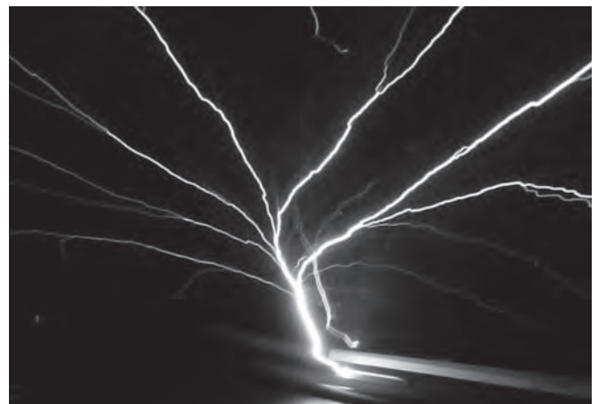
Elektrostatische Entladung (Elmsfeuer) an der Frontscheibe bei hoher atmosphärischer Feldstärke.
