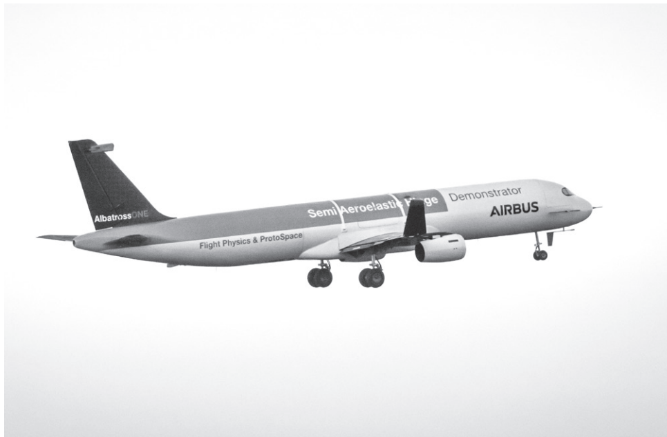
Inspiziert vom Albatros erforscht Airbus die Vorteile frei schwingender Flügelspitzen.
