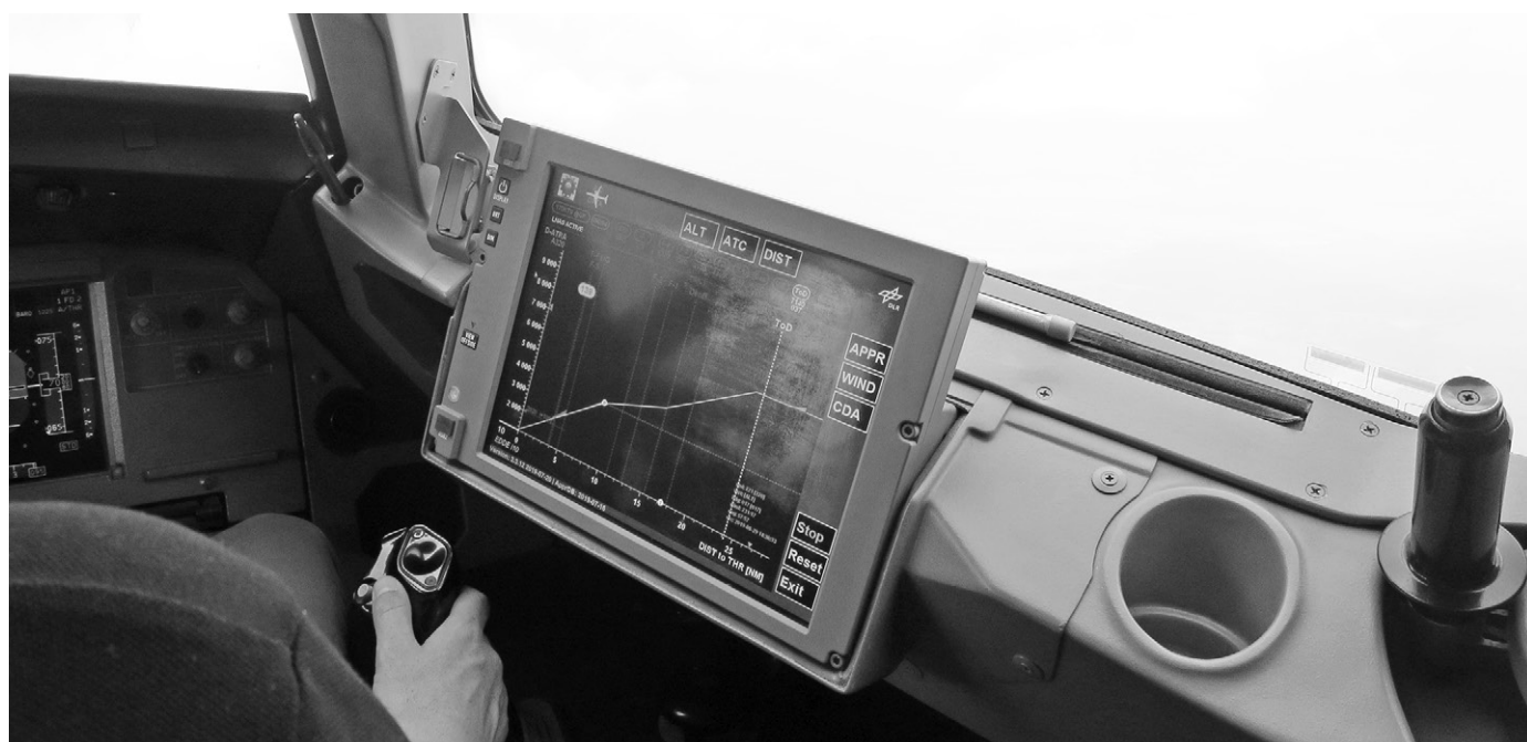
Darstellung des optimalen Anflugprofils mit Handlungsempfehlungen für die Piloten auf einem Electronic Flight Bag.
