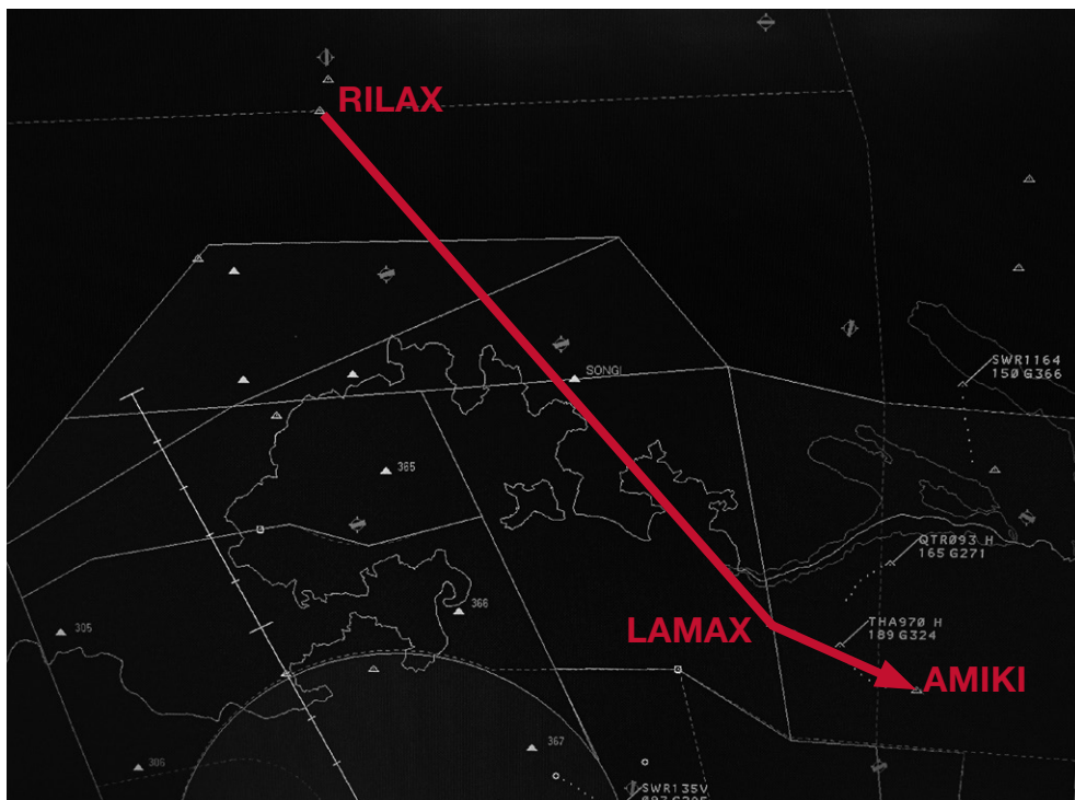
«RILAX 1A»-STAR (RILAX-LAMAX-AMIKI) auf dem Radarschirm eingblendet. Ebenfalls zu sehen sind die Schweizer Grenze in der Region Schaffhausen sowie einige Waypoints der AMIKI-34-Transition.
