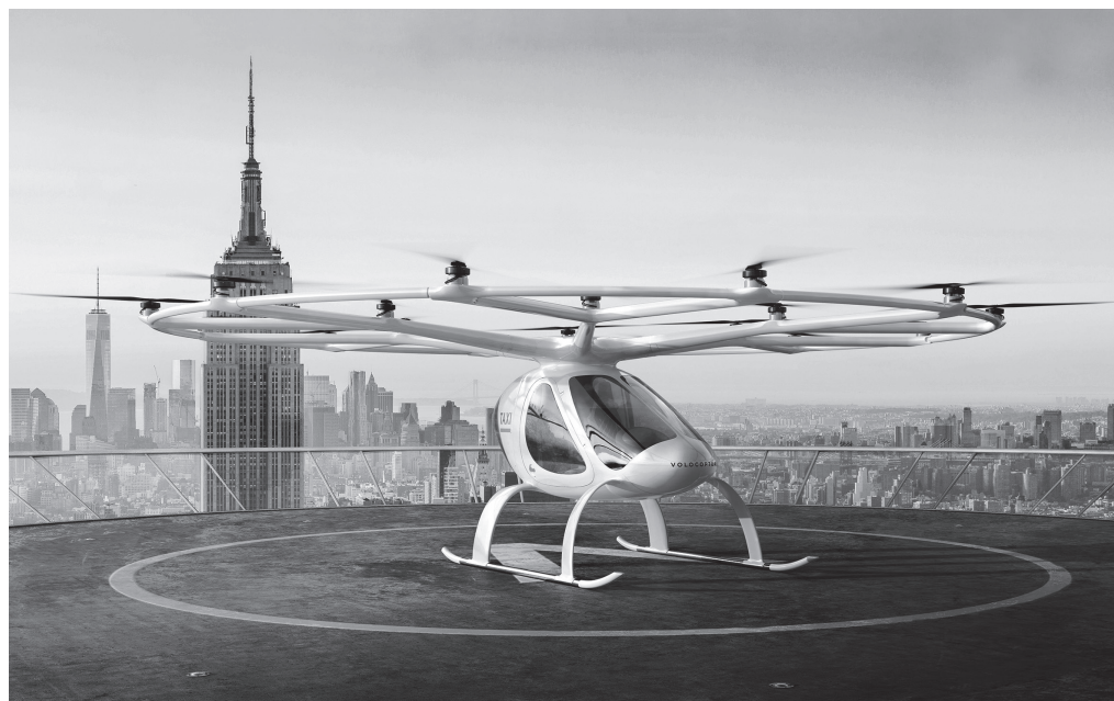
Der Volocopter 2X verfügt über eine Reichweite von 27 Kilometern. 2016 erhielt er als erster Multikopter eine Verkehrszulassung.
