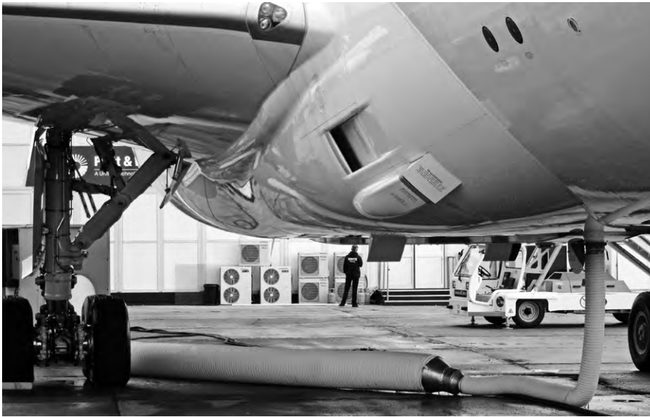
Durch diese Inlets gelangt bei der B-787 frische Luft zu elektrisch betriebenen Kompressoren, die eine TCP-freie Belüftung garantieren.
