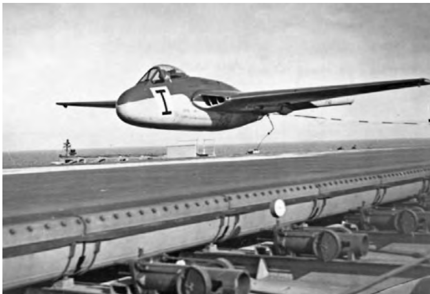
Landeversuch ohne Fahrwerk.
