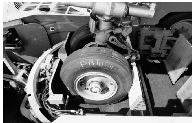
Bugradaufnahme mit Drehteller des TaxiBots, um die Steuerausschläge des Bugrads an den TaxiBot zu übertragen.
