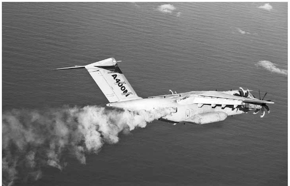
Ein A400M verteilte eine Tonne Vulkanasche in rund 10 000ft Höhe. Die erzeugte Aschewolke war etwa drei Kilometer lang und 200 Meter hoch. Die Aschekonzentration betrug nominell 1 mg/cbm und damit deutlich weniger als die bis zu 2 mg/cbm, die von Triebwerkherstellern als vertretbar eingestuft werden.
