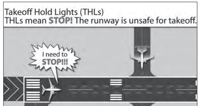
Die Takeoff Hold Lights leuchten, weil ein Fahrzeug auf der Piste steht. (Quelle: www.rwsl.ll.mit.edu )
