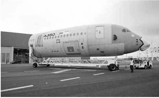
Livraison à Toulouse d'un tronçon du fuselage d'un A350XWB.
