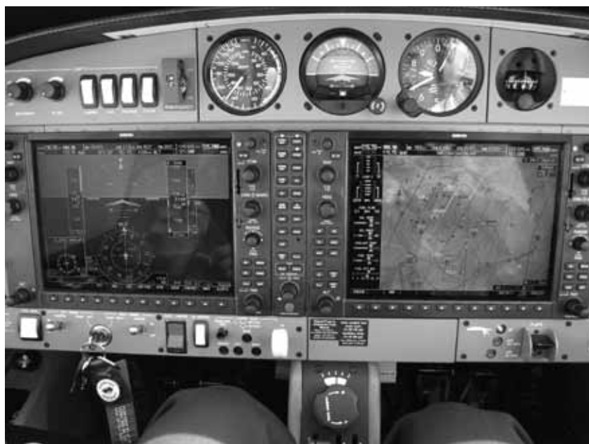
Dank des Garmin-1000-Glas-Cockpits ist der Arbeitsplatz in der DA42 aufgeräumt.
