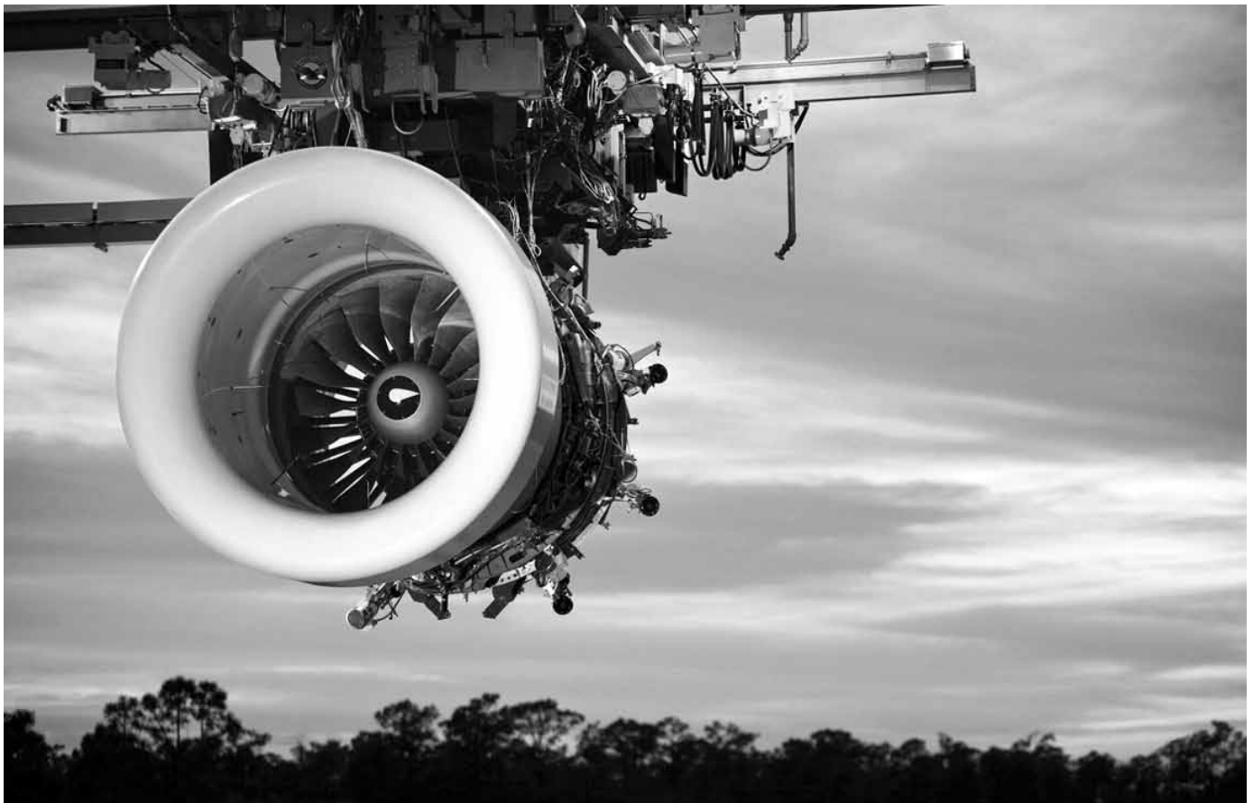
Testvorrichtung für das PW1000G in West Palm Beach, Florida.
