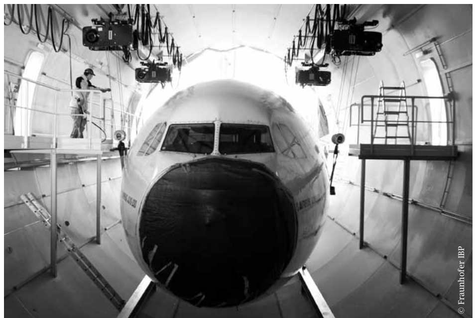
Ausgiebig: Während des «Flugs» können zahlreiche Einflüsse auf die Kabinatmosphäre simuliert werden.
