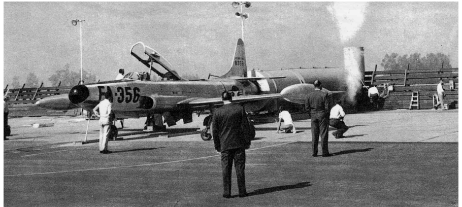
Die Lockheed F-94C vor einem Maxim-Schalldämpfer mit Wasserkühlung
