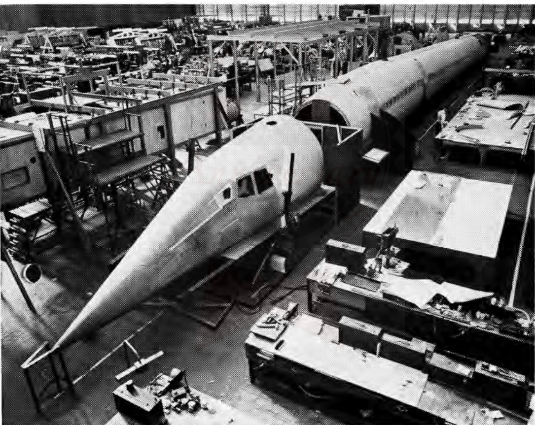
Abb. 1. In der Montagehalle der British Aircraft Corporation Bristol Division wurde bereits im vergangenen Sommer ein sogenannter «Mock-up», das heisst ein Modell in natürlicher Grösse, des britisch-französischen Ueberschall-Verkehrsflugzeuges «Concorde» aufgebaut.
