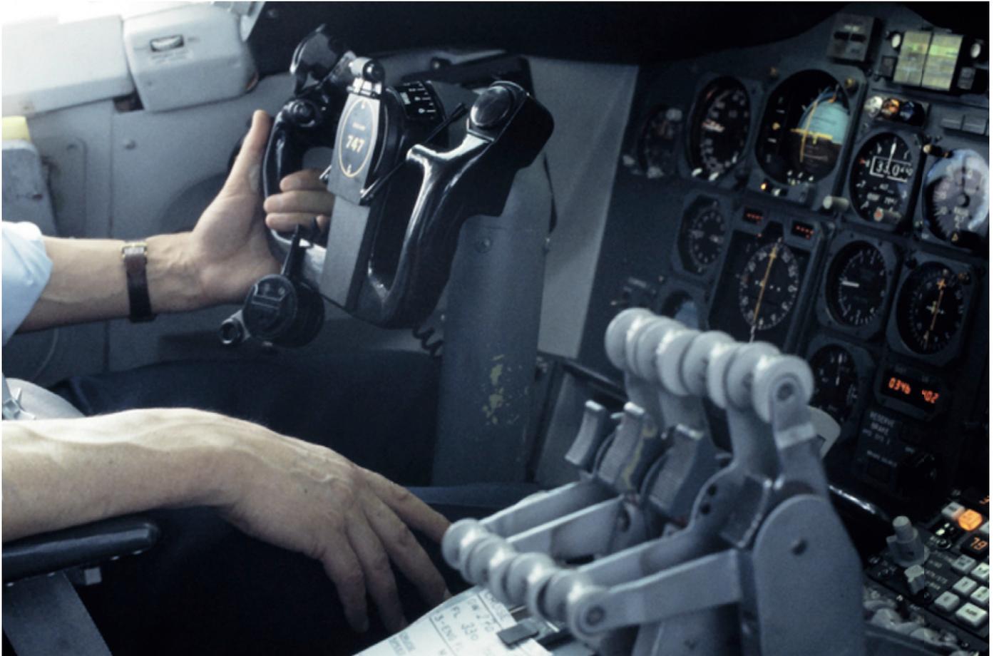
Die vier Schubhebel mit den Verlängerungen im 90-Grad-Winkel, die der Flight Engineer benutzte, um den Take-off und Climb Thrust einzustellen.
